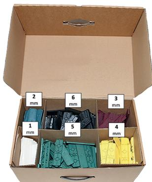
**TOPFORM Verglasungsklötze sind aus hochwertigem Polypropylen und in verschiedenen Farben erhältlich. Dabei symbolisieren die unterschiedlichen Farben die unterschiedliche Stärke der Klötze. TOPFORM Verglasungsklötze enthalten keine Weichmacher und sind daher randverbundverträglich.**
