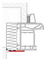
**Flachleiste mit Lippe selbstklebend. Aufgerolltes Endlosmaterial im Schutzkarton.**
