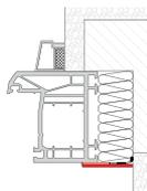
**Flachleiste selbstklebend. Aufgerolltes Endlosmaterial im Schutzkarton.**
